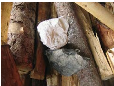
Abb. 124: Kalkkurs in Sent. Kalkgestein (grau) und ge- brannter Kalk (weiss).
